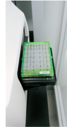
6. "Run assay" 로 넘어가서 "start run" 누른 뒤 utility plate 넣어준다 (이 때 기기들의 모양에 맞게 왼쪽 아래의 사선모양에 맞추어 plate 를 넣어준다
